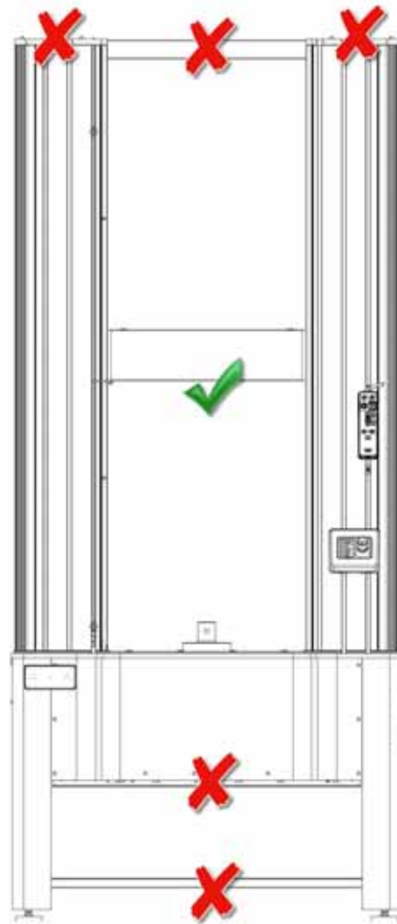
図 21. クロスヘッドの下のみを持ち上げる
