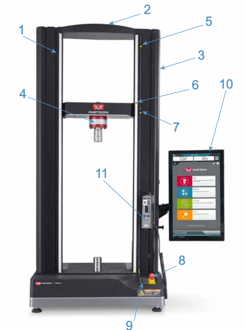
図 1. Bluehill® オペレータ ダッシュボード 付きの 6800 デュアル コラム卓上モデル - 正面図
