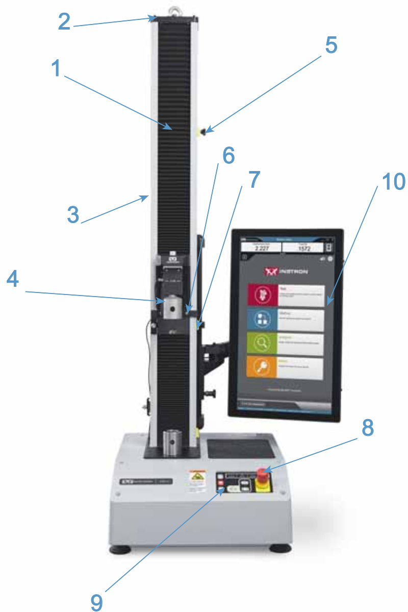
図 1. Bluehill® オペレータ ダッシュボード 付きの 3400 シングル コラム卓上モデル - 正面図
