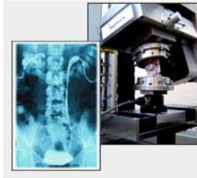
ミネソタ大学は、器具の改良のための重要なステップとして、背骨の自然な運動の特性を研究しています。背骨の運動は複雑な6自由度です。これらの自然な運動に対するインプラントの影響を評価するには、器具を装着した場合としない場合の背骨の比較をしなければなりません。インプラントの影響は必ずしも局所的なものではなく、隣接した椎体に影響を与える場合もあります。したがって、エンジニアは、脊椎の固定器具の影響を完全に理解し、背骨の他のセクションの運動についても特性を評価することが必要になります。インストロンの6軸試験機で得られる試験データは、インプラントが装着された部分および隣接した椎体における動作の制限や耐荷重性能を明らかにします。
