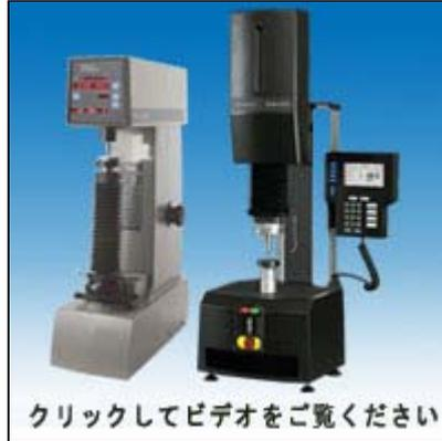
ごく最近、他の荷重適用方法として、**閉ループ**式硬さ試験技術が開発されました。閉ループ式試験機は、錘を積み重ねる代わりに、荷重測定装置(ロードセル)を使い、電動アクチュエータにより、適用する荷重を調整します。このシステムは、荷重を絶えず監視して調整するので、荷重の誤差をなくし、試験機の精度や再現性を向上させることができます。
