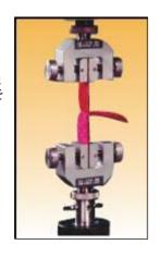
す。これらは、様々なタイプの粘着テープの試験に適しています。プリント配線回路 基板フォイルの接着は、2820シリーズのフローティングローラー治具を使い測定す ることができます。これは硬質な基材から軟質のラミネートを剥離する試験に適し ています。
