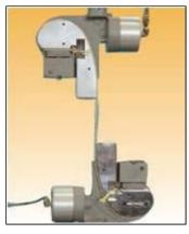
金属の疲労試験は、さまざまな機械式および油圧式予圧グリップを使用して実施できます。
