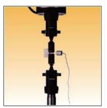
2665自動アベレージング伸び計は、標点距離をソフトウェアで指定でき、また、試験開始時および終了時に接触アームを自動的に開閉できるので、優れた生産性と使いやすさを提供します。疲労試験には、極めて優れた動的性能を持つ伸び計が必要となります。2620シリーズクリップオン伸び計は、小型軽量で高い共振周波数を持っているので、ひずみ制御で実行する試験などを含め、疲労試験に最適です。2670シリーズき裂開口変位(COD)計は、破壊力学の試験に適しており、様々な測定範囲、標点距離、および温度範囲でご使用いただけます。
