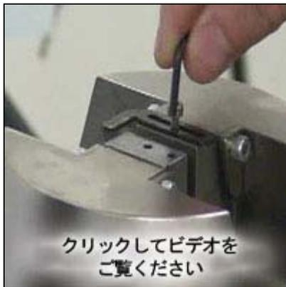
複数のオペレータの間で、適切なアライメントと正確な結果を得られるようにするには、試験片アライメント装置の使用を推奨します。これらの試験片センタリング装置(「L」字型)はグリップに取り付けられ、試験片をグリップフェース内で中心にセットする補助をします。センタリング装置はオペレータの手で調整可能であり、試験片が中心にくるように、かつ、挿入され過ぎないようにします。一度オペレータがセンタリング装置を正しくセットしてしまえば、その後の各試験片はグリップの中で同じ位置に取り付けられることになり、正確で再現性のある結果を得ることが可能です。
