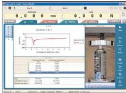
Bluehill 2 のビデオキャプチャモジュールは、試験の開始から終了まで、データと同時に試験全体を記録します。試験のビデオキャプチャ機能は、オンデマンド再生により、細部にわたる試験内容やタイムフレームに至るまで、簡単にレビューすることを可能にします。試験終了後、関連する試験ビデオフレームを確認しながら、スキャンカーソルで特定の試験ポイントを選択できます。また、ビデオは電子データとして保存および送信できます。
