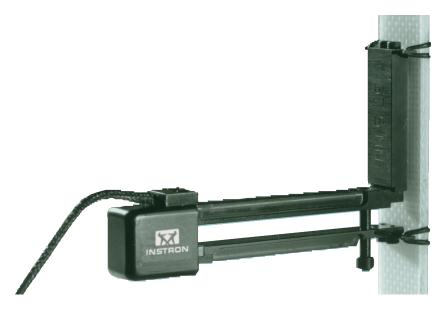
2620シリーズ動的ひずみゲージ式伸び計はさまざまな静的材料試験と高周波繰り返し試験のアプリケーションで正確なひずみの直接測 定やクローズドループ制御に使用することができる精密で軽量な伸び計です。
