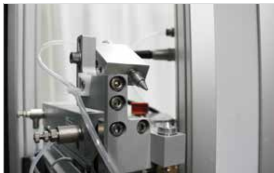
オイル潤滑システム
