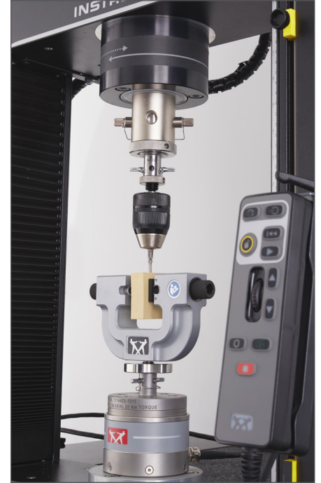
ASTMF543へ準拠した骨ねじ試験
