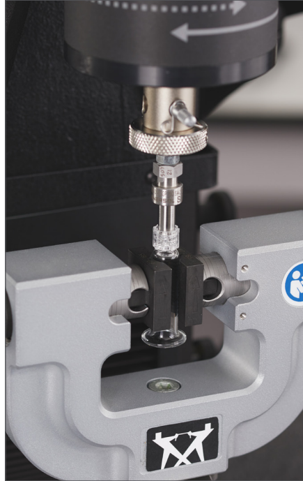
ISO80369へ準拠したルアーロック接続部の低トルク試験
