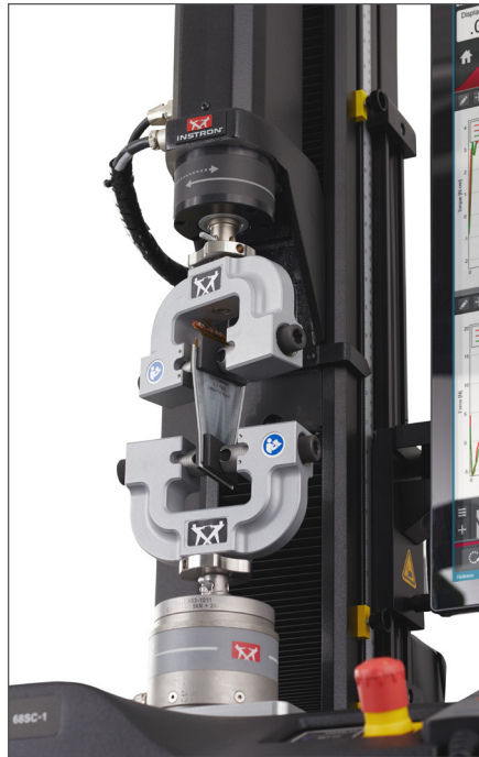
フレキシブル基板の繰返し試験
