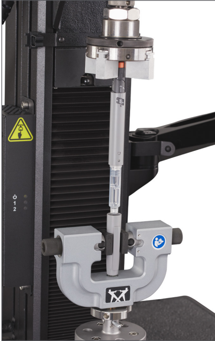
ペン型注射器の使用試験
