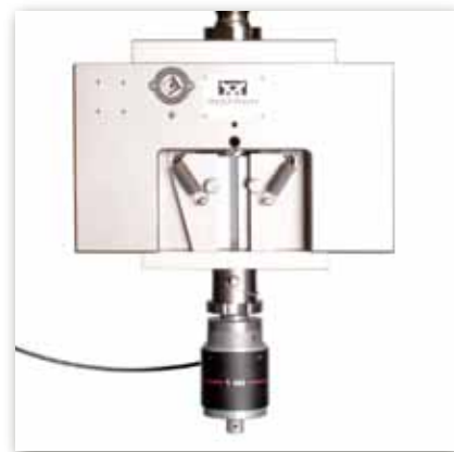
2501-700アダプターに装着された低荷重ロードセル
