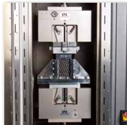
圧縮盤2501-704と2501-705の間に置かれた衝撃後圧縮取り付け具
